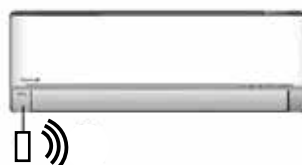
Wifi-sovitin CZ-TACG1 asennetaan pumpun sisään tai viereen.
